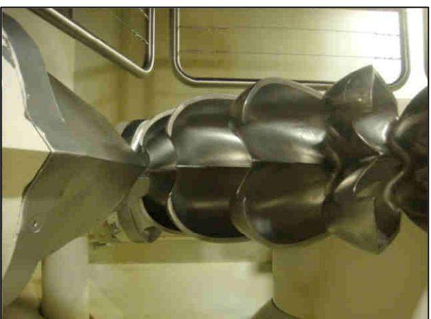
**Fünfstrahlige Vertikal-Pelkonturbine** zur Stromproduktion der FM Gougna in Chippis/VS im 21. Jh.
